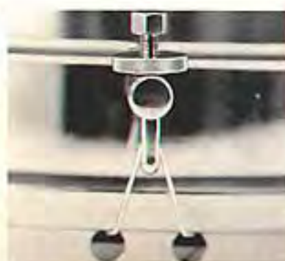
Für die gleichmäßige Auflage des Spiralteppichs ist eine zweite Reguliermöglichkeit durch die Stimm-schraube wichtig
